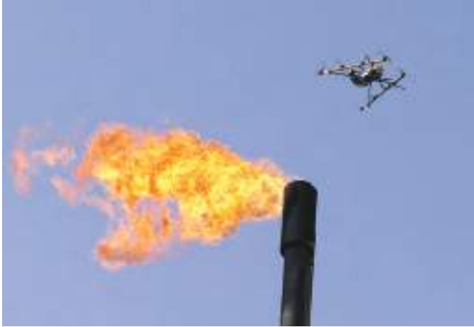
الاستخدام الرئيسي للطائرات بدون طيار هو تفقد الشعلات الحية في حقول النفط
